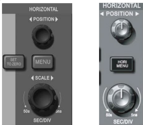
Рисунок 1-10. Зона управления горизонтальной разверткой на панели управления осциллографов с 5,7-дюймовым дисплеем (слева) и 7-дюймовым дисплеем (справа)
