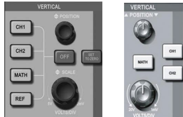
Рисунок 1-9. Зона управления вертикальной шкалой на панели управления осциллографов с 5,7-дюймовым дисплеем (слева) и 7-дюймовым дисплеем (справа)
